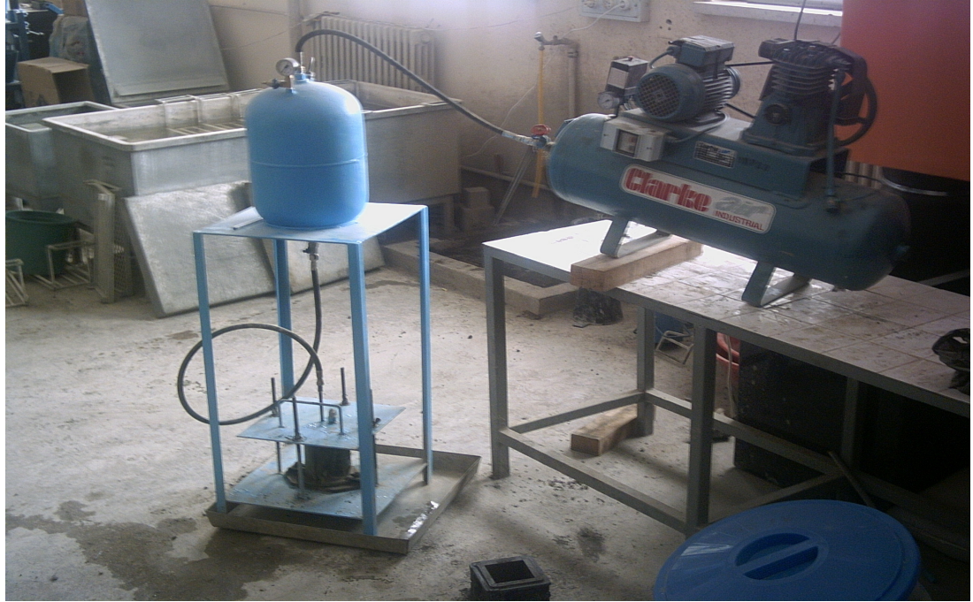
Fotoğraf 5.2. Numunelere Çimento Enjeksiyonu Uygulanması
