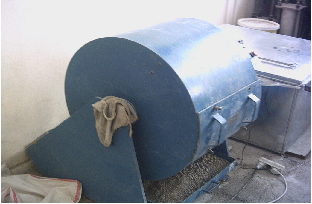
Fotoğraf 6.3. Los Angeles (Aşınma) Aleti
