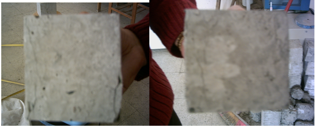
Fotoğraf 6.2. Basma Aletinde Yüzeysel Kırılmış Numuneler
