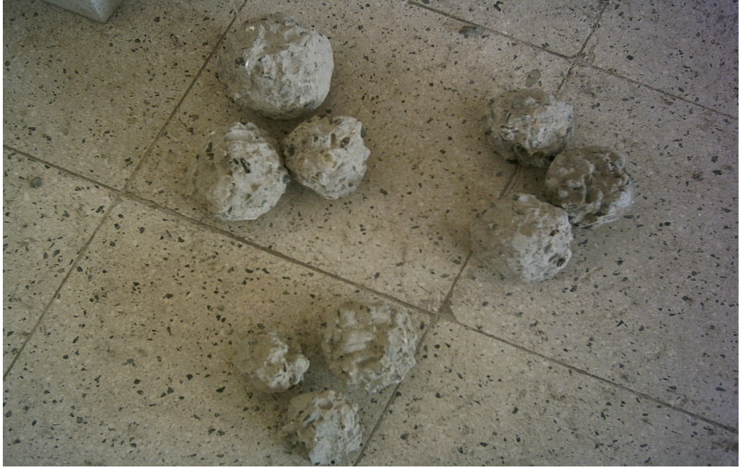
Fotoğraf 6.4. 100 ve 500 Devir Sonrası Numunelerin Görünümü
