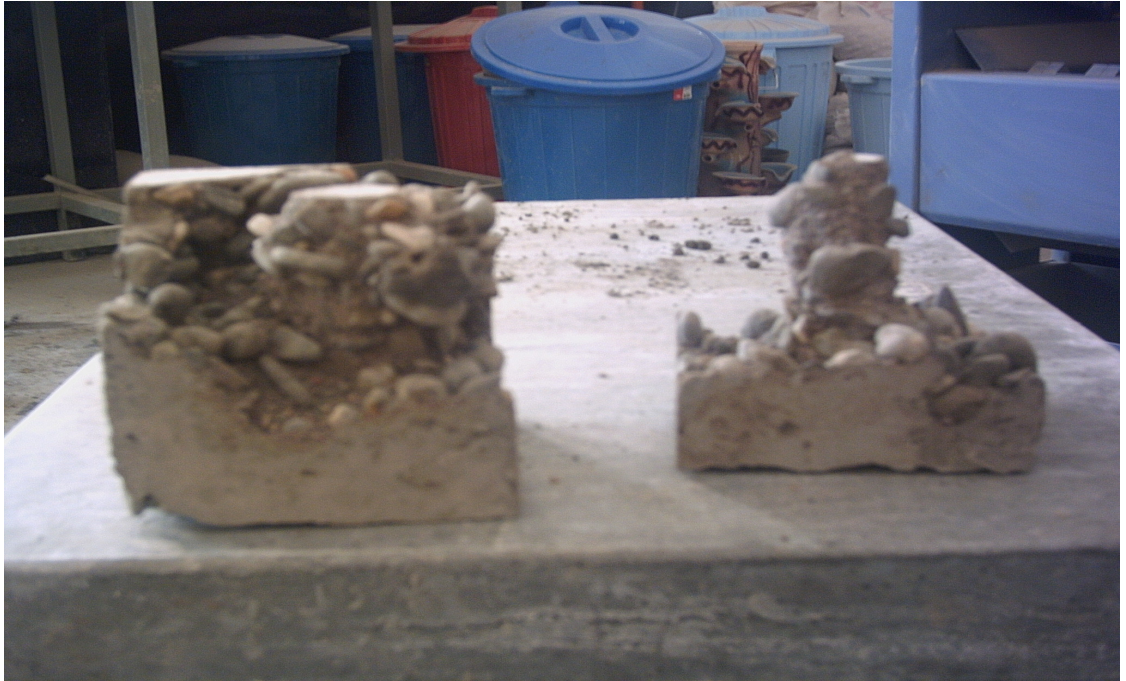
Fotoğraf 5.3. Kısmi Enjeksiyon Olmuş Numuneler
