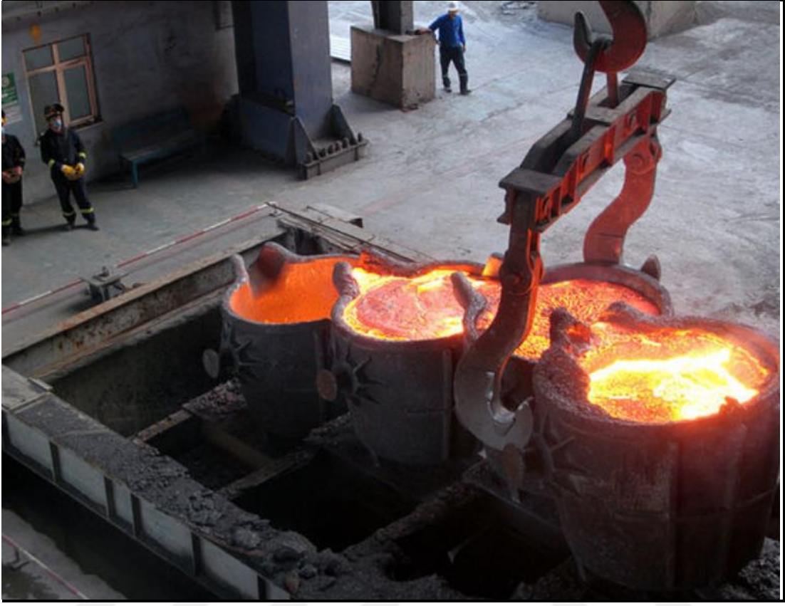
Foto 40. Ferrokrom üretiminde ergitme yapılırken
