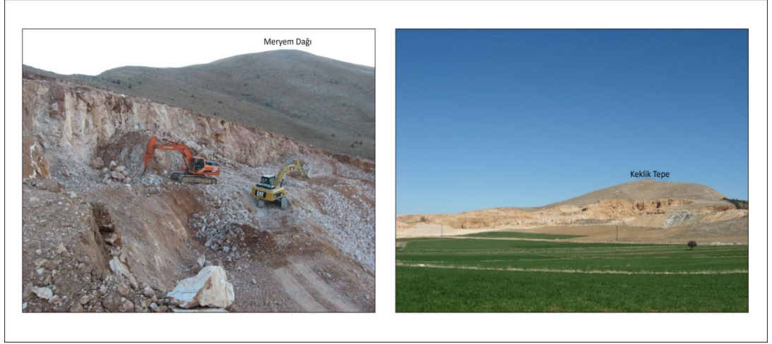
Foto 16. Meryem Dağı ve Keklik Tepenin Yamaçları boyunca Taş Ocağı İşletmesine Bağlı Olarak Meydana Gelen Yamaç Gerilemesi
