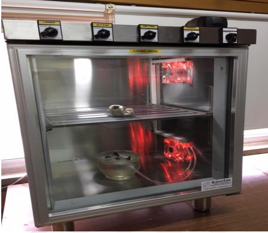
Şekil 9. Gaz kürlere ünitesi
