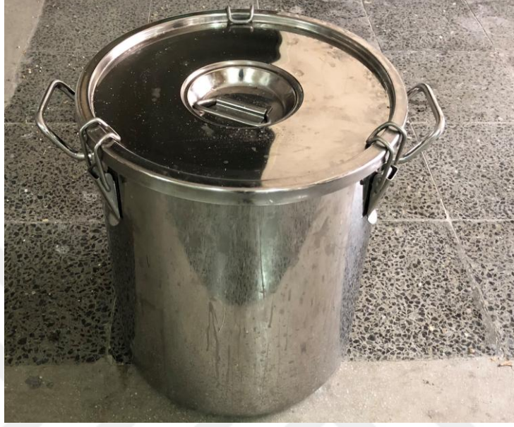
Şekil 3. Hava sızdırmaz çelik kazan
