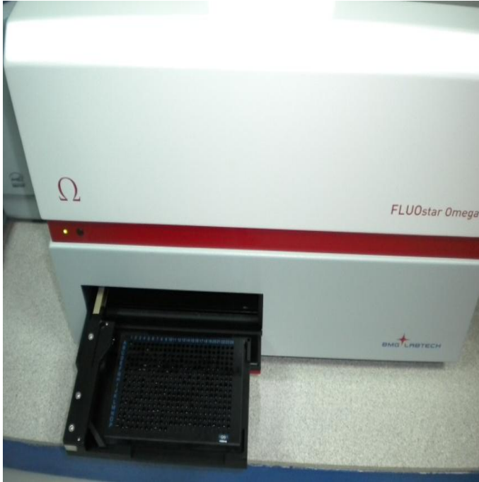
Şekil 27. Fluorescence Multiple Reader ve 384 odacıklı mikroplate'in görünümü.
