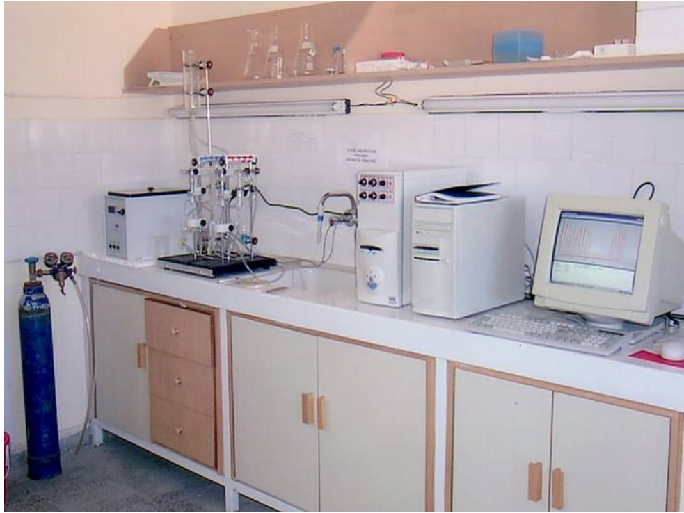
Şekil 4. Miyometriyal şeritlerde kontraktıl aktivitenin izlendiği iki kanallı ısıtıcılı (ceketli) izole organ banyo sistem seti
