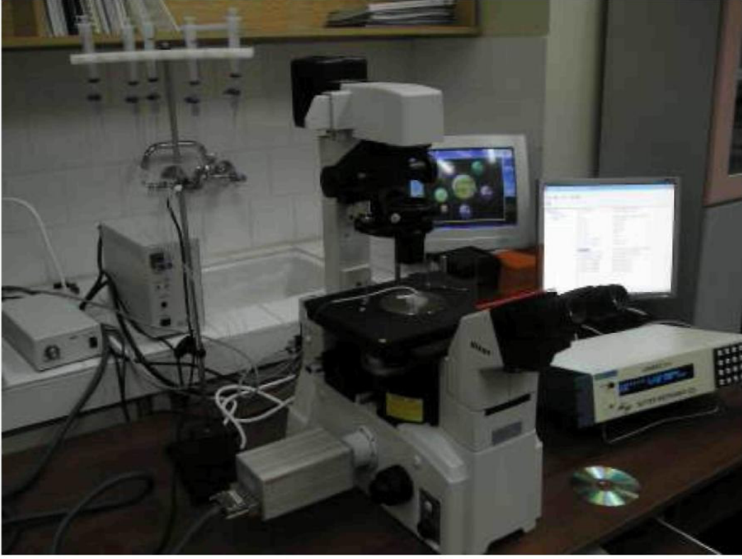
Şekil 4.2. Flüoresan kalsiyum görüntüleme sisteminin fotoğrafik görünümü. İlaç uygulama/mikroinkübasyon sistemi (sol üst kısım), CCD kamera (sol alt), ters mikroskop ve filtre sürücüsü kontrol ünitesi (sağ).
